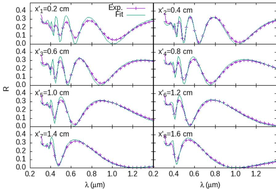
*Figura 5.4: Espectros de reflectancia en diferentes posiciones ( $x'_n = 0.2 - 1.6 \text{ cm}$ ,  $y = 0.74 \text{ cm}$ ) de la muestra  $S_1$  preparada mediante una corriente  $I_1 = 5 \text{ mA}$ . Mostramos resultados experimentales y los resultados ajustados a través de las ecs. (4.18) y (4.19)*
