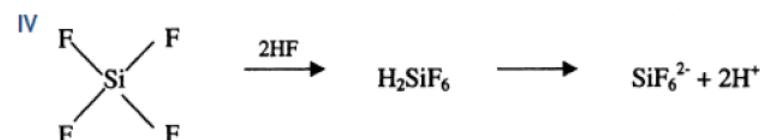
**El tetrafluoruro de silicio reacciona con dos moléculas de HF para producir ácido fluorosilícico ( $\text{H}_2\text{SiF}_6$ )**
