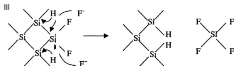
**Ataque del HF a un enlace Si-Si. Los átomos remanentes de Si en la superficie se enlazan a átomos de H y una molécula de tetrafluoruro de silicio ( $\text{SiF}_4$ ) es producida**
