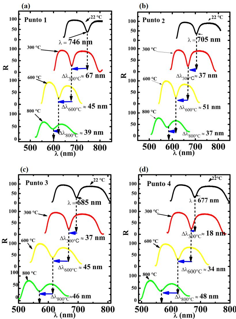
Figura 3.4: Espectros de reflectancia  $100R$  vs. longitud de onda  $\lambda$  de las microcavidades de Si-p mostradas en la fig. 3.3 preparadas mediante anodización asimétrica seguidas de un tratamiento térmico medidas en los puntos 1-4 indicados. Se indican las longitudes de onda a las que está entonada la microcavidad en cada punto y sus corrimientos debidos a los tratamientos térmicos.
