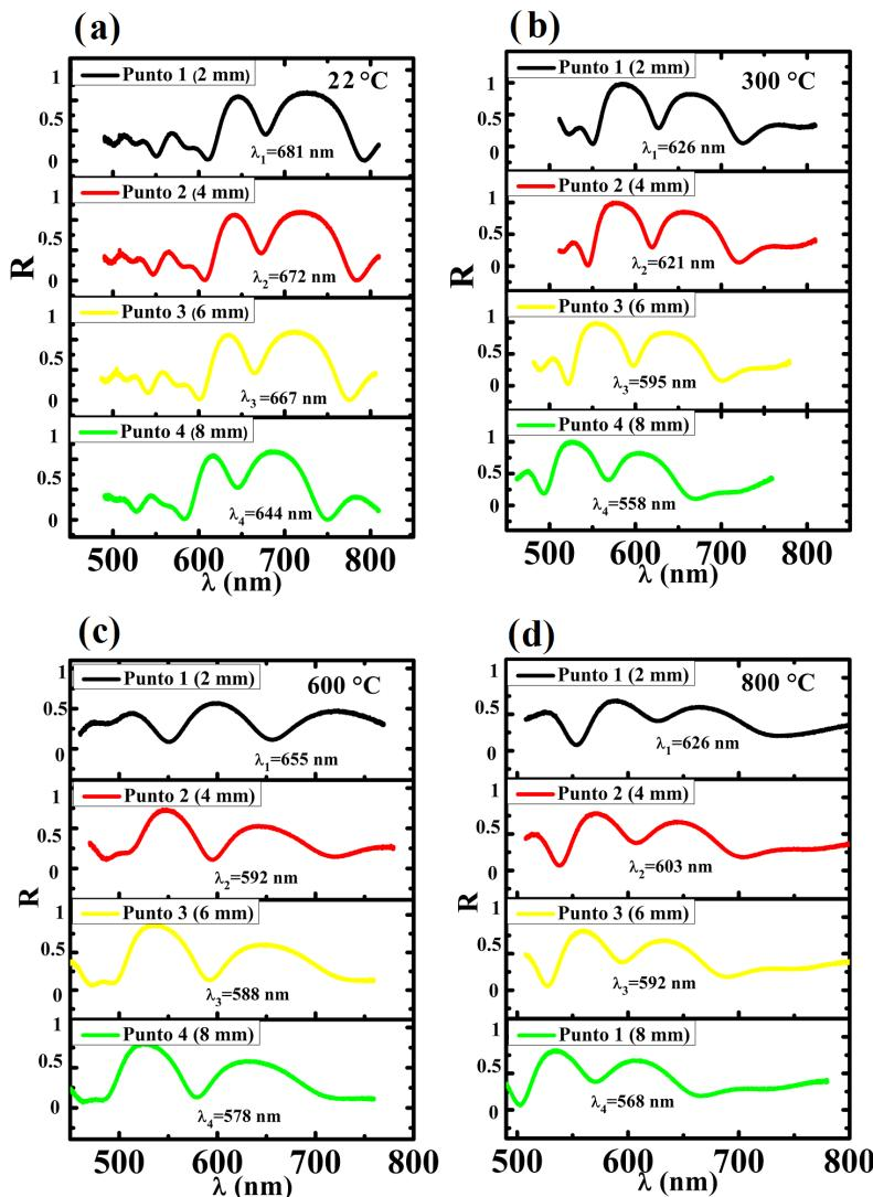
Figura 3.6: Espectros de reflectancia  $R$  vs.  $\lambda$  en los puntos 1-4 (paneles (a)-(d)) de las microcavidades MCL de Si-p mostradas en la fig. 3.5, preparadas mediante anodización asimétrica, separadas del sustrato, transferidas a un soporte de cuarzo y oxidadas mediante un tratamiento térmico.
