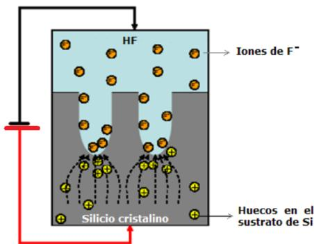
Figura 2.4: Esquema simplificado del proceso electroquímico de anodización del Si-c en un proceso de corriente controlada. Los iones  $F^-$  contenidos en la solución electrolítica y los huecos presentes en la oblea de Si son las principales especies electroactivas que intervienen en el proceso de anodización. El ataque ocurre sólo en las puntas del poro en las que los huecos ( $h^+$ ) son enfocados por el campo eléctrico [36].
