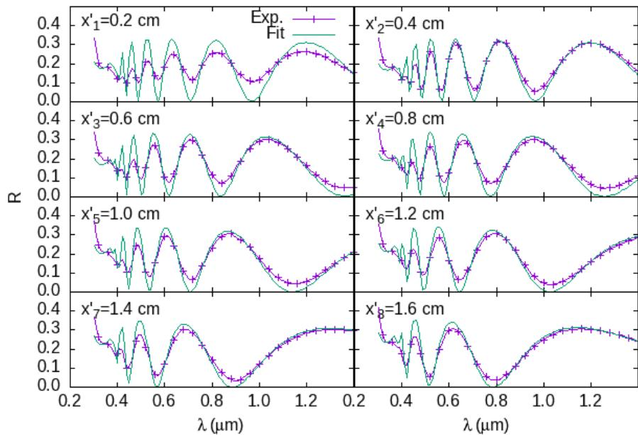
Figura 5.5: Espectros de reflectancia en diferentes posiciones ( $x'_n = 0.2 - 1.6 \text{ cm}$ ,  $y = 0.74 \text{ cm}$ ) de la una muestra  $S_2$  preparada mediante una corriente  $I_2 = 10 \text{ mA}$ . Mostramos resultados experimentales y resultados ajustados a través de las ecs. (4.18) y (4.19)
