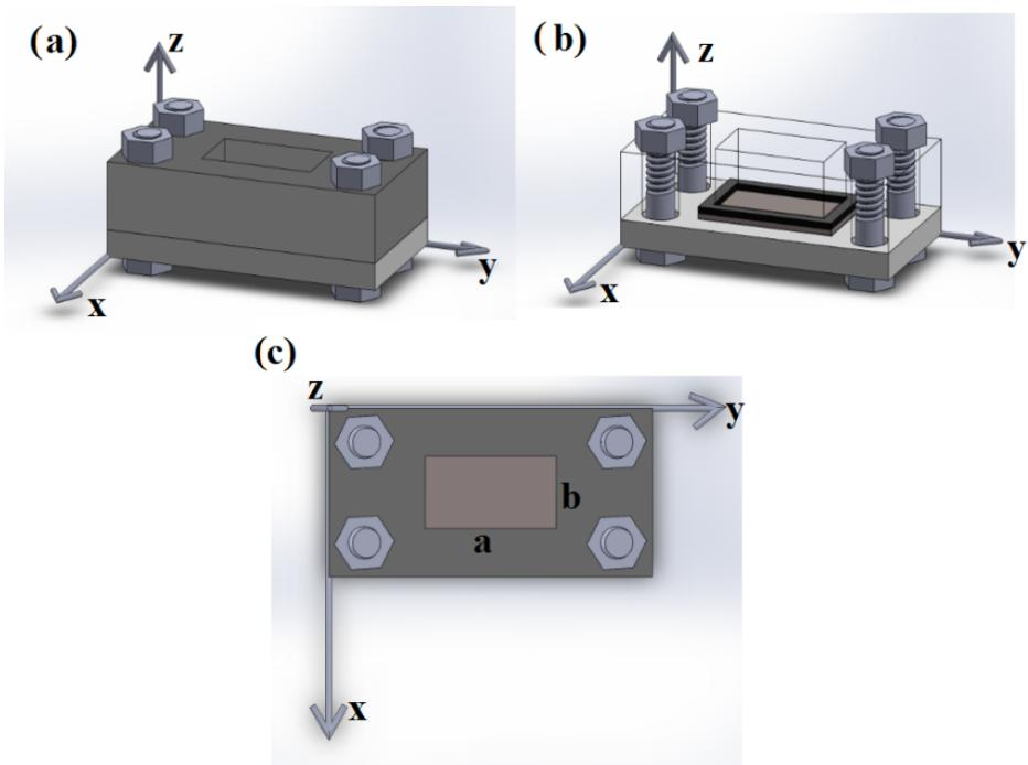
Figura B.1: La celda electrolítica dibujada en 3D tiene la forma de un prisma rectangular como se muestra en la fig. 4.4, con una base de lados  $a = 2.01\text{ cm}$  y  $b = 1.48\text{ cm}$ , con un área de muestra descubierta de aproximadamente  $3\text{ cm}^2$ .
