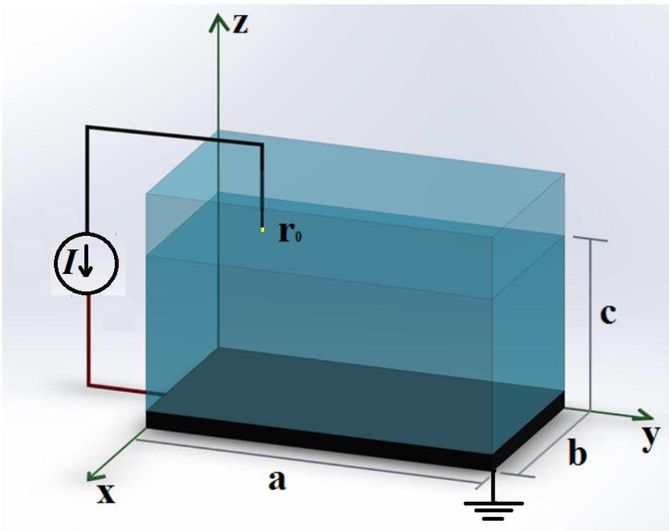
Figura 4.1: Celda electrolítica en forma de prisma con una base rectangular de lados  $a$ ,  $b$  lleno de electrólito hasta una altura  $c$ . Las paredes de la celda son aislantes y el fondo está completamente cubierto por la muestra, que se supone que es un buen conductor. La punta del electrodo es un alambre delgado y aislado con solo la punta descubierta y ubicada en  $\mathbf{r}_0 = (x_0, y_0, z_0)$  dentro del líquido. La corriente fluye a través del electrólito de la muestra a la punta.
