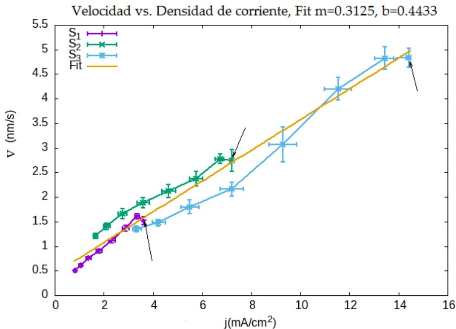
Figura 5.8: Velocidad de ataque (etching rate) vs. densidad de corriente  $j_{\perp}$  para las tres muestras  $S_1$ ,  $S_2$ ,  $S_3$ . Las flechas apuntan a los datos que corresponden a posición  $x'_1 = 0.2 \text{ cm}$  (ver el texto). Incluimos un ajuste lineal de la forma  $v = m j_{\perp} + b$  con  $m = (0.312 \pm 0.017)(\text{cm}^2/\text{mA})(\text{nm}/\text{s})$  y  $b = (0.44 \pm 0.09)\text{nm}/\text{s}$ .
