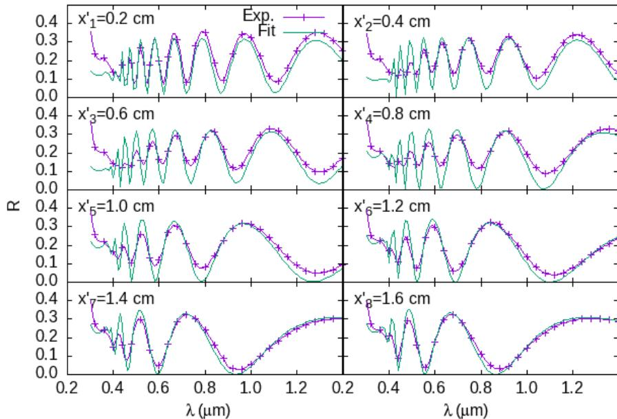
Figura 5.6: Espectros de reflectancia en diferentes posiciones ( $x'_n = 0.2 - 1.6 \text{ cm}$ ,  $y = 0.74 \text{ cm}$ ) en la muestra  $S_3$  preparada mediante una corriente  $I_3 = 20 \text{ mA}$  (Fig. 5.2). Mostramos resultados experimentales y resultados ajustados a través de las ecs. (4.18) y (4.19)
