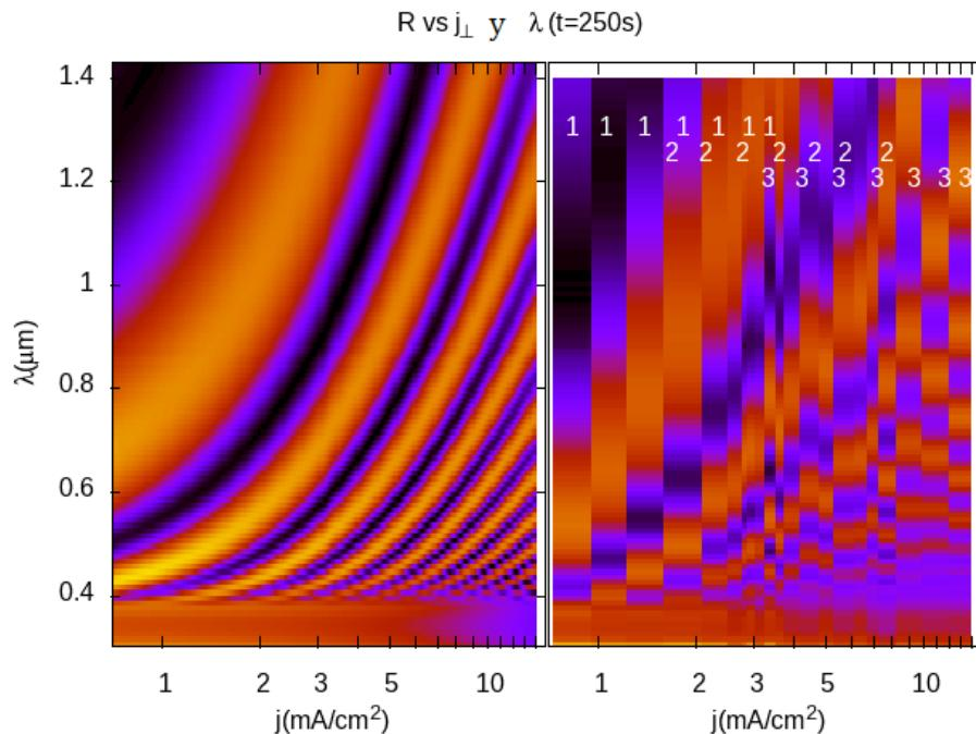
Figura 5.9: Reflexión  $R$  de una película de Si-p en función de la densidad de corriente  $j_{\perp}$  y longitud de onda  $\lambda$  para un tiempo de grabado de  $t = 250$  s. Resultados teóricos (panel izquierdo) y experimentales (panel derecho, ver texto). Indicamos con los números 1, 2, 3 los datos correspondientes a las muestras  $S_1$ ,  $S_2$  (desplazado, ver texto) y  $S_3$ .
