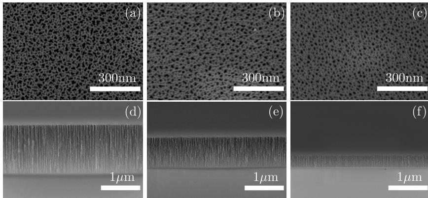
Figura 5.3: Micrografías SEM con vistas superiores (paneles (a), (b) y (c)) y laterales ((d), (e) y (f)) de la muestra  $S_3$  tomadas de una región cercana al lado izquierdo ((a) y (d)), al centro ((b) y (e)) y al lado derecho ((c) y (f)) en la línea central que se muestra en la fig. 5.2.
