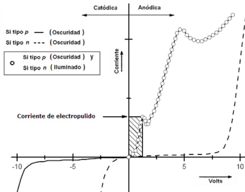
Figura 2.3: Características corriente-voltaje ( $I - V$ ) típicas en el proceso de anodización para Si tipo n y tipo p en solución acuosa de HF. La región dentro del rectángulo corresponde al régimen útil donde se puede obtener Si-p. En el régimen anódico, las características de una celda electroquímica con Si tipo n estarán en la región delimitada por las características en oscuridad (línea punteada) y con cierta iluminación (círculos vacíos) (tomado de la ref. [34])
