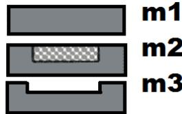
*Figura 2.6: Definición de las masas ( $m_i$ ) que intervienen en el cálculo de la porosidad:  $m_1$  es la masa inicial de la oblea de Si,  $m_2$  es la masa de la oblea de Si después de la anodización de una película porosa y  $m_3$  es la masa del Si después haber disuelto la película porosa.*
