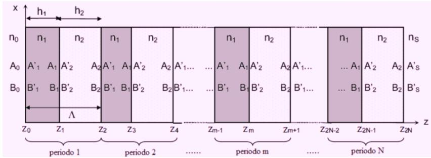
Figura A.1: Esquema de un sistema de multicapas.  $A_m$  y  $B_m$  representan las amplitudes de ondas viajando hacia la derecha e izquierda dentro de la capa  $m$  de espesor  $h_m$  y con índice de refracción  $n_m$ . La estructura está inmersa en un medio homogéneo con índice de refracción  $n_0$  y descansa sobre un sustrato con índice de refracción  $n_s$  [60].
