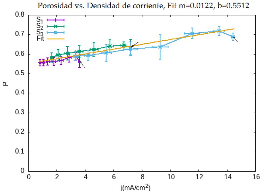
Figura 5.7: Porosidad vs. densidad de corriente para las tres muestras  $S_1$ ,  $S_2$ ,  $S_3$ . Las flechas apuntan a los datos que corresponden a la posición  $x'_1 = 0.2\text{ cm}$  (ver el texto). Incluimos un ajuste lineal de la forma  $p = mj_{\perp} + b$  con  $m = (0.0122 \pm 0.001)\text{cm}^2/\text{mA}$  y  $b = 0.551 \pm 0.005$ .
